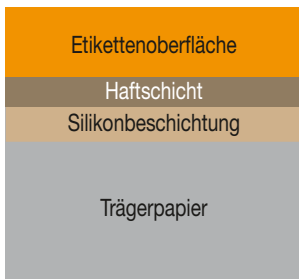
Aufbau eines Haftetiketts mit Trägerpapier und Silikonbeschichtung
